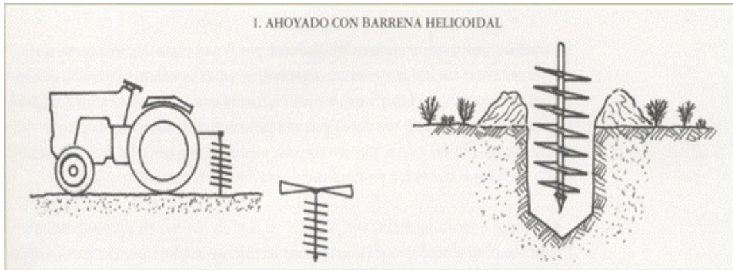
Figura 9: El esquema representa la labor de apertura de hoyos con barrena helicoidal (Fuente: Navarro Cerrillo, R. y Martínez Suarez, A. Ed.1996 Forestaciones en Explotaciones Agrarias. Junta de Andalucía. Consejería de Agricultura y Pesca)
