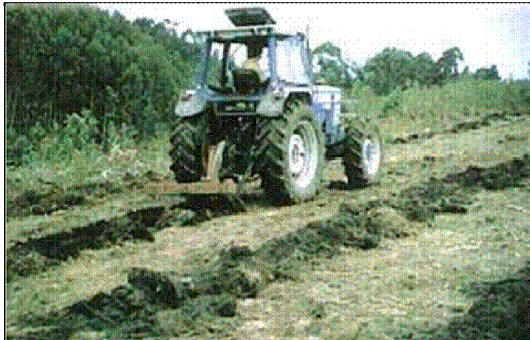
Figura 2: La fotografía muestra un pase de subsolado lineal con 2/3 rejones (Fuente: www.agrobyte.com )
