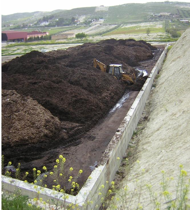
de la era. Sobre estos cordones descargan los remolques de alperujo y una vez producido el desagüe del mismo gracias al filtrado de la hoja se mezclan ambos materiales con una pala cargadora. La altura de las pilas la van incrementando según el proceso de descomposición avanza y la mezcla se va secando y tomando consistencia. A partir de mitad de primavera y durante el verano utilizan la misma
