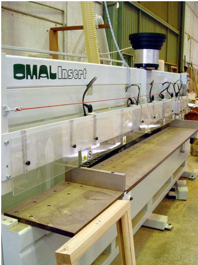
Nuevo taladro clavijador punto a punto CNC de Omal que recientemente Zuhaizki ha adquirido a Maesma.
