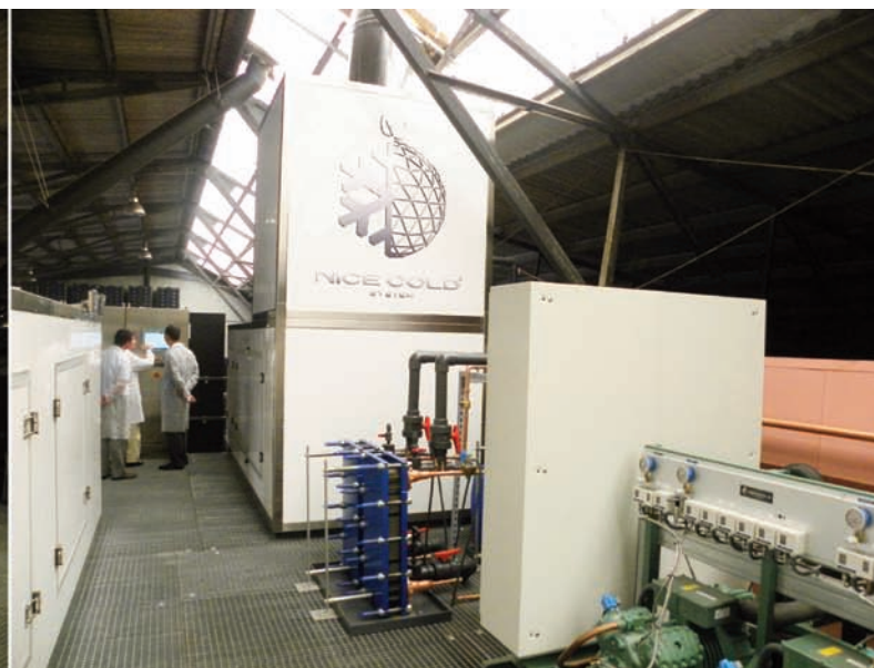
La máquina consta de dos módulos, uno que realiza el proceso de deshidratación (izq.) y el otro el de estabilización (dcha.).
