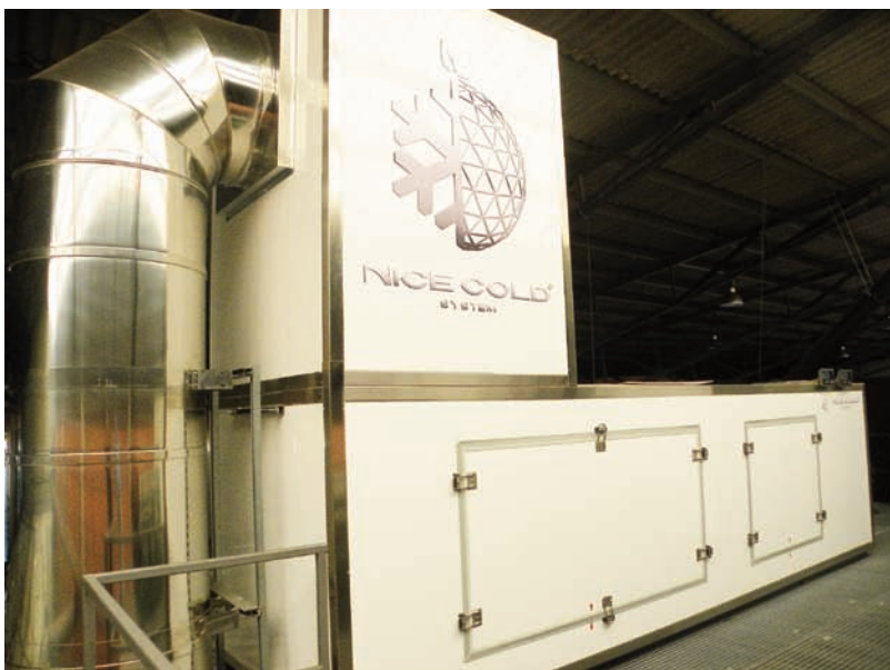
La máquina consta de dos módulos, uno que realiza el proceso de deshidratación (izq.) y el otro el de estabilización (dcha.).
