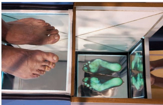
El IBV dispone de un Laboratorio de Valoración Funcional de Calzado con varios equipos que evalúan aspectos relacionados con el confort del calzado como la fricción, flexibilidad, estabilidad, amortiguación de impactos o la distribución de presiones.
