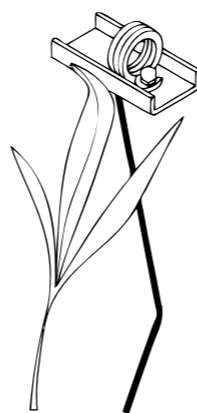
Dispositivo de protección del muelle que impide el pinzado de las puntas de las hojas
