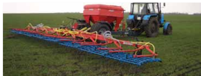
Almohaza de 12 m con sembradora "AIR Cart Air 16" 2.000 l
