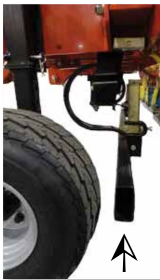
Placa niveladora con muelle, 1,5 m para nivelar toperas, montículos, etc..
