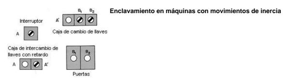
Cuando la máquina no detiene el movimiento de sus órganos móviles peligrosos al desconectar el interruptor, hay que proveer al sistema de una caja de intercambio de llaves con retardo; esta caja dispondrá de un temporizador que impedirá la extracción de la llave A' hasta transcurrir el tiempo prefijado para que la máquina pare totalmente.
