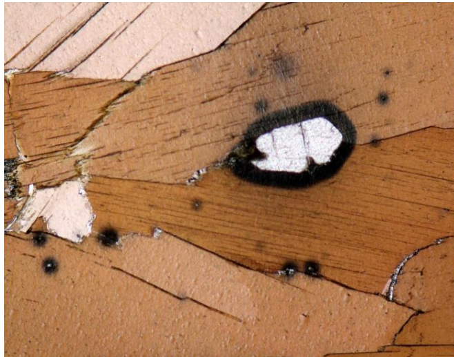
Figura 31. Halo pleocroico alrededor de zircón dentro de biotita, producido por la liberación de partículas radiactivas del zircón hacia la biotita.
