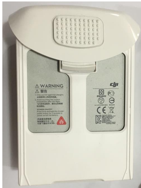
Figura B.6 La figura muestra la batería inteligente del dron Phantom 4 de la marca DJI
