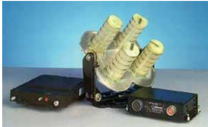
Figura 2.27 Ejemplo de arreglo de antena helicoidal del satélite MCA-6010 (Aerospace online, 2016)
