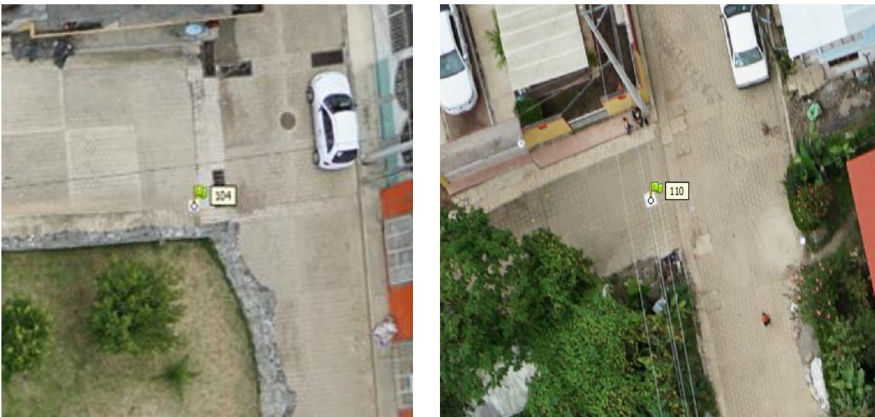
Figura 2.16 Imágenes aéreas donde se observa el desplazamiento de los objetos a partir del centro
