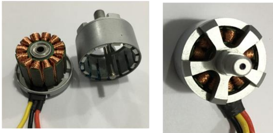
(a) Vista interior del motor (b) Vista exterior del motor
