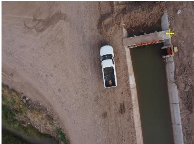
Figura 5.16 Identificación de un punto de control, Sinaloa en una imagen de un canal de riego en Los Mochis, Sinaloa
