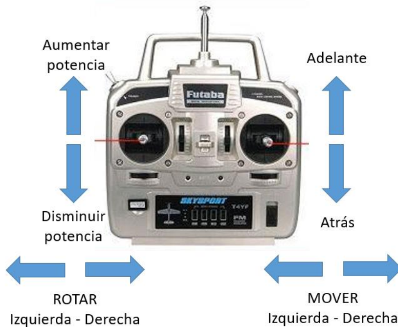
Figura 4.21 Movimiento de los bastones de la emisora y respuesta del VANT (modo 2)
