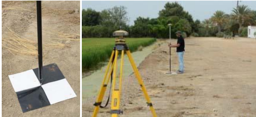
Figura 4.12 Dianas para la ubicación de puntos de control en el terreno (izquierda) y GPS diferencial (derecha)
