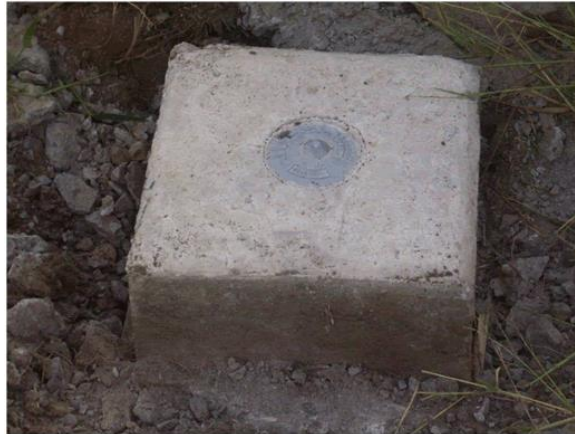
Figura 2.14 Banco de la red geodésica de INEGI
