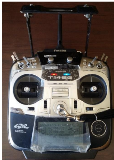
Figura 3.4 Radio control o emisora de mando remoto
