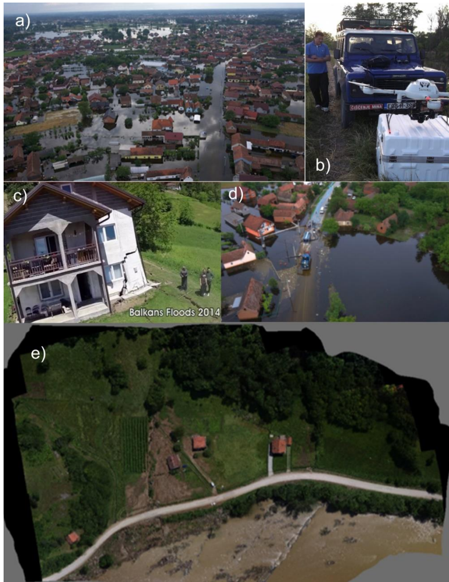
Figura 5.25 a) Fotografía aérea tomada con un dron ICARUS, b) Dron cuadrirotor ICARUS c) Detección de fisuras en casas, d) Ubicación de bombas de alta presión, e) Ortomosaico elaborado a partir de fotografías aéreas (De Cubber et al. , 2014)
