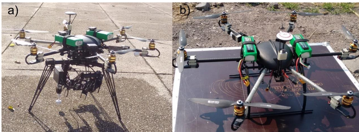
Figura E.18 Baterías colocadas en hexacóptero con a) montura de tres ejes y b) Patín de entrenamiento
