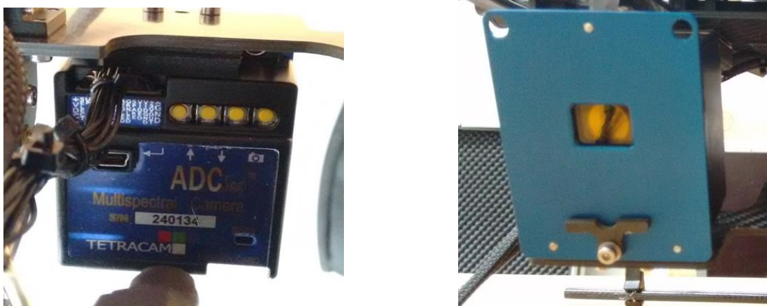
Figura 4.3 Cámara multiespectral TETRACAM. Vista trasera izquierda, vista frontal derecha
