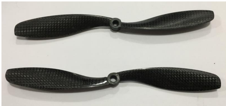
Figura B.4 Hélices de fibra de carbono para cuadricóptero
