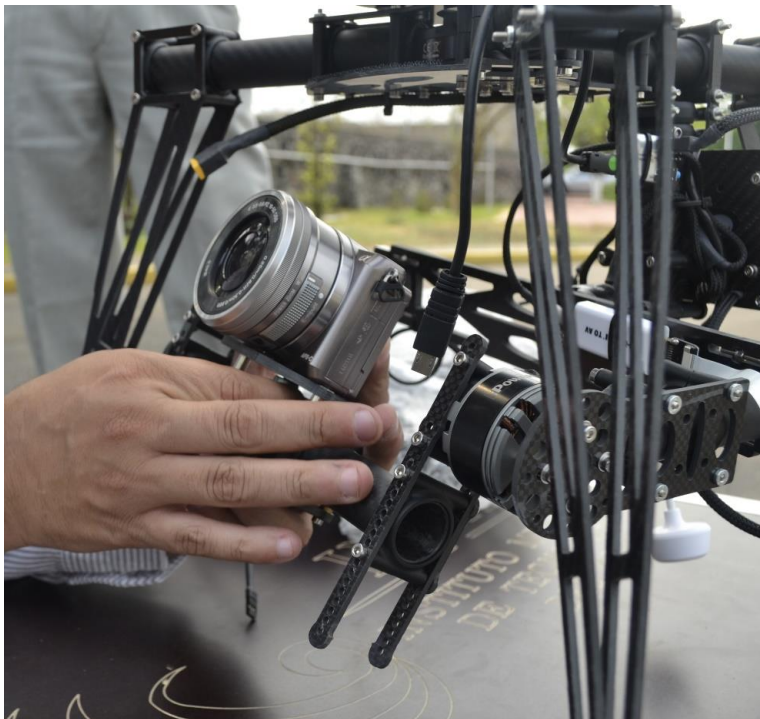
Figura 5.32 Montura especial de VANT para montar cámara de alta resolución para realizar actividades de supervisión de infraestructura hidráulica
