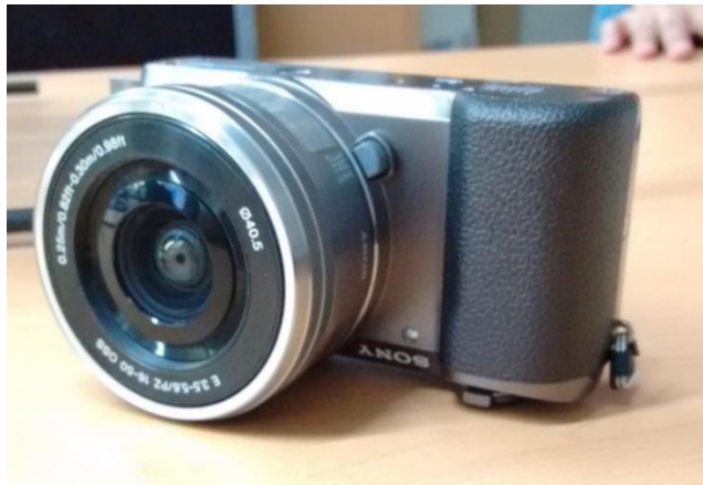
Figura 4.4 Cámara visible SONY de 26 megapíxeles
