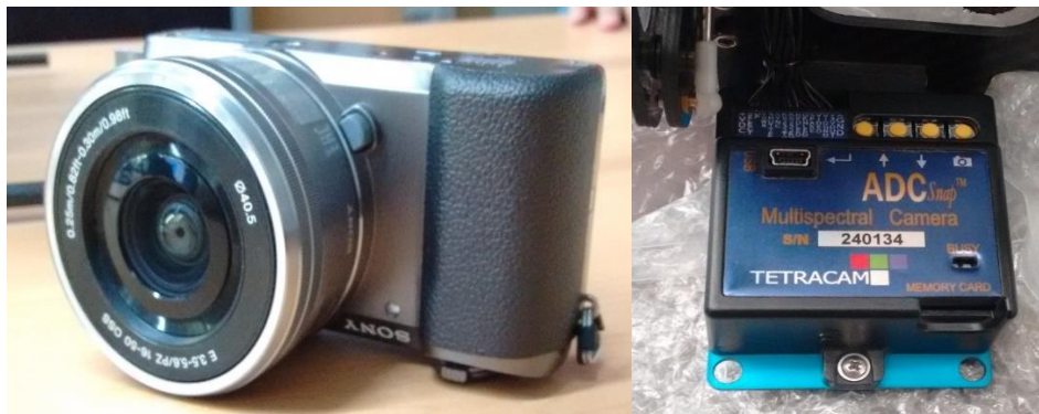
Figura E.3 Cámara Visible SONY y multiespectral ADC Snap
