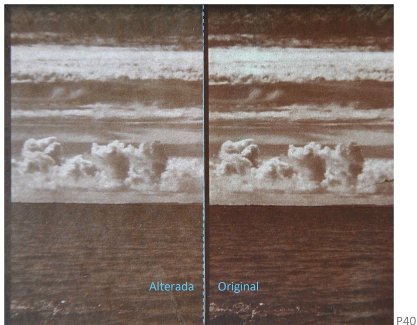
P40. Imagen de detalle de la zona indicada en la imagen P38, que muestra la pérdida de densidad de forma comparativa. A la derecha se muestra una imagen no degradada ya la izquierda la sometida a elevada temperatura por permanecer bajo material negro y exposición solar continuada. (Fuente: Imagen propia)
