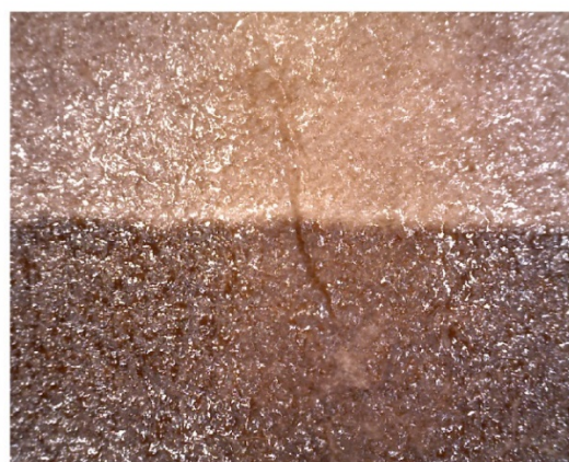
P6. Imagen tomada durante la realización de la prueba de solubilidad con agua fría. Se indica la zona examinada bajo aumentos antes y después de la prueba (imágenes P7 y P8, respectivamente)
