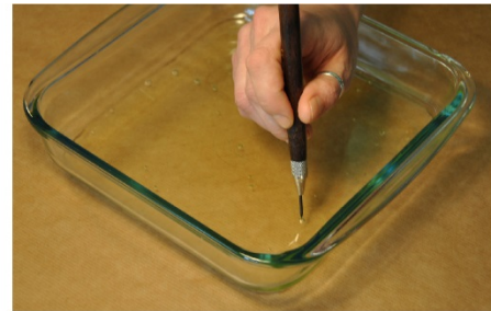
R16. Eliminación de burbujas en la película de albúmina con punzón
