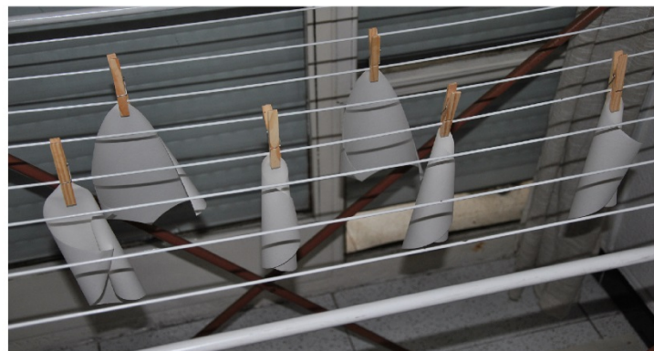
R21. Varios papeles albuminados durante el proceso de secado. La contracción de la albúmina hace curvar sus extremos hacia el interior
