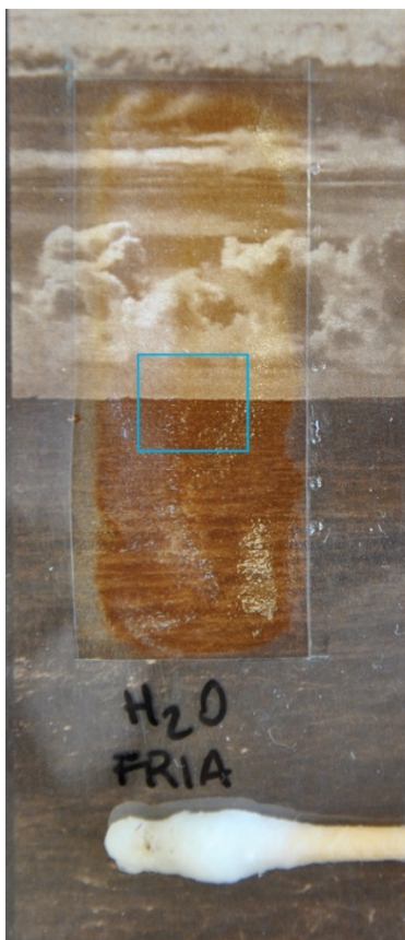
P6. Imagen tomada durante la realización de la prueba de solubilidad con agua fría. Se indica la zona examinada bajo aumentos antes y después de la prueba (imágenes P7 y P8, respectivamente)
