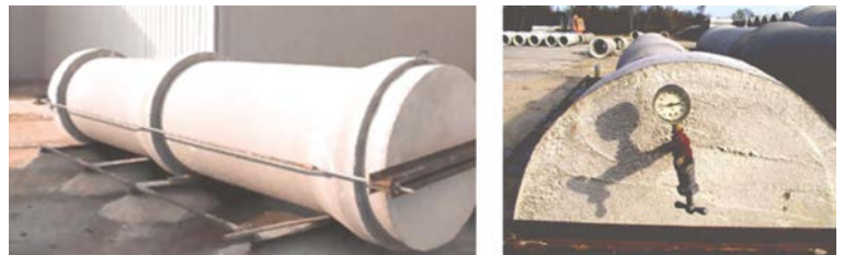
Figura 1.19 Ensamble y medición de la prueba hidrostática
