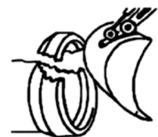
Figura 1.35 Mala práctica de instalación de tuberías
