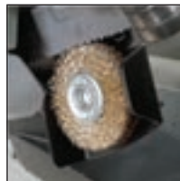
Πίσω οδηγός με βούρτσα καθαρίσματος κορδέλας
