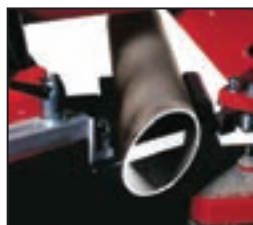
Γωνία κοπής ρυθμιζόμενη από 0° ως 45° αριστερά
