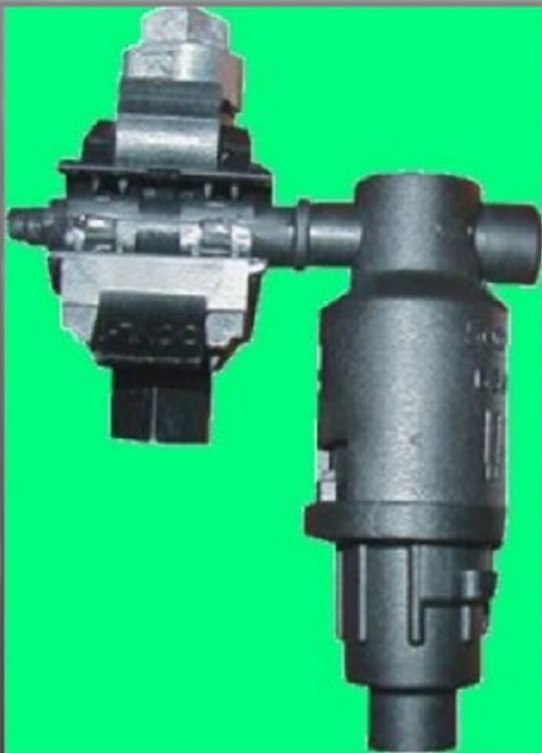
DCPAE CONECTOR PORTAFUSIBLE HORIZONTAL Conector con acople rápido para corte conexión y protección hasta 63A, orientable estanco principal 10/95 y derivación 1,5/10mm 2
