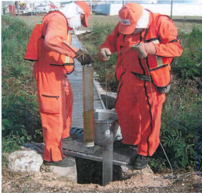
Figura 11 Medición del nivel estático en un pozo con presencia de hidrocarburos (producto libre). (Cortesía de II-UNAM. 2009)
