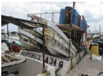
FIGURA 12. Embarcación mayor nodriza utilizada en la pesquería de langosta de Yucatán (alijos con motor fuera de borda).
