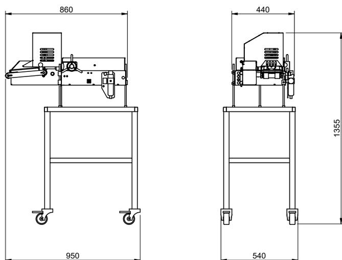
Formadora automática de croquetas y albóndigas que se acopla a cualquier embutidora con salida de producto simple o doble y con la posibilidad de conectarse en línea con una rebozadora.
