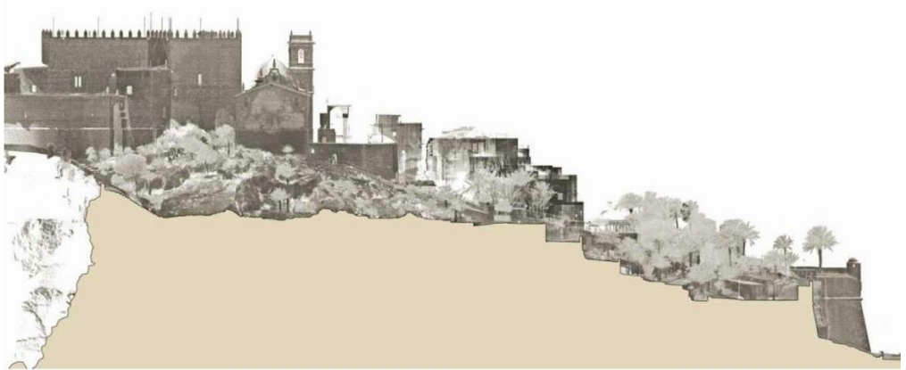
Fig. 2- Sezione del centro storico di Peniscola ottenuta dalla nuvola di punti laser scanner, nella quale avviene in relazione il volume del castello con lo sviluppo dei sistemi difensivi rinascimentali.
