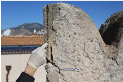
Fig. 15 - Il prelievo con tampone.
