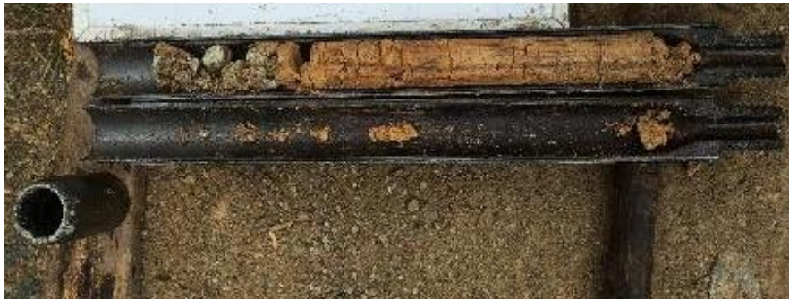
Foto 54 Roca blanda encontrada en las perforaciones realizadas para la Obra N°4 Fuente: El Autor
