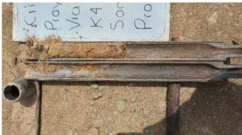
Foto 53 Roca blanda encontrada en las perforaciones realizadas para la Obra N°3 Fuente: El Autor
