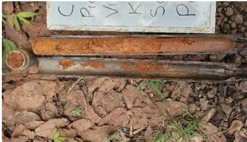
Foto 61 Suelo residual encontrado en las perforaciones realizadas para la Obra N°8 Fuente: El Autor
