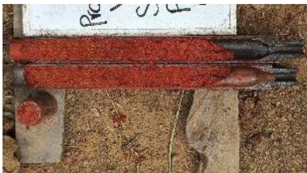
Foto 57 Suelo residual encontrado en las perforaciones realizadas para la Obra N°6 Fuente: El Autor
