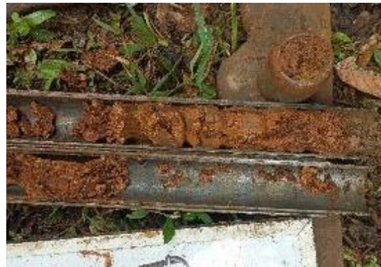
Foto 63 Roca blanda encontrada en las perforaciones realizadas para la Obra N°9 Fuente: El Autor
