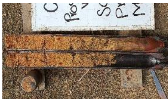
Foto 58 Roca blanda encontrada en las perforaciones realizadas para la Obra N°6 Fuente: El Autor
