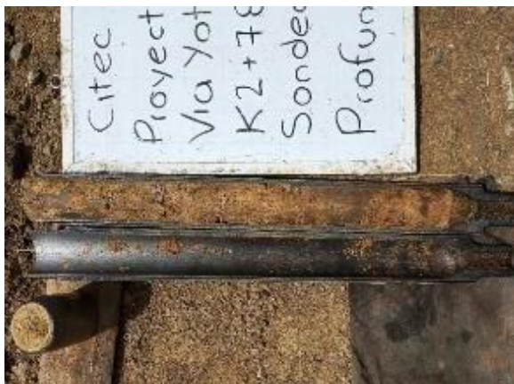
Foto 49 Suelo residual encontrado en las perforaciones realizadas para la Obra N°1 Fuente: El Autor
