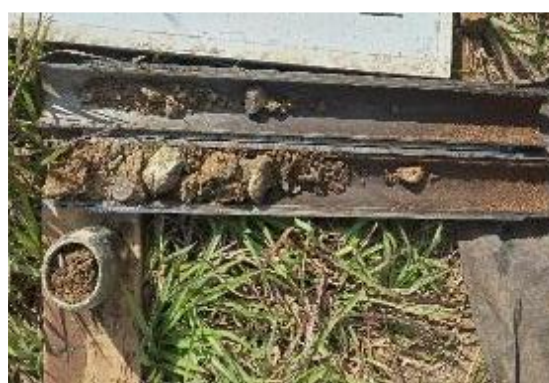
Foto 52 Roca blanda encontrada en las perforaciones realizadas para la Obra N°2 Fuente: El Autor
