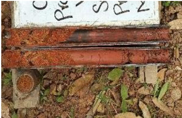
Foto 62 Suelo residual encontrado en las perforaciones realizadas para la Obra N°9 Fuente: El Autor
