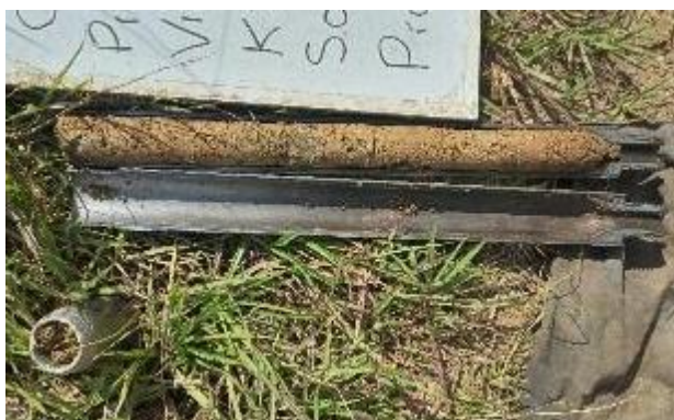
Foto 51 Suelo residual encontrado en las perforaciones realizadas para la Obra N°2 Fuente: El Autor
