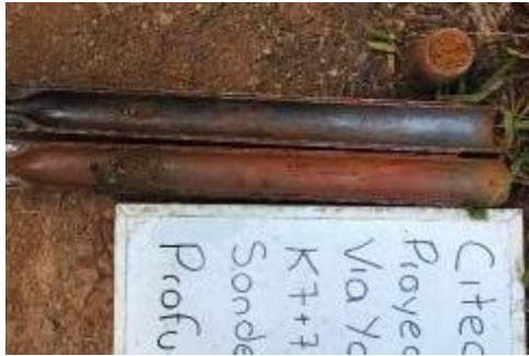
Foto 59 Suelo residual encontrado en las perforaciones realizadas para la Obra N°7 Fuente: El Autor
