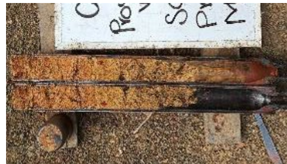
Foto 58 Roca blanda encontrada en las perforaciones realizadas para la Obra N°6
