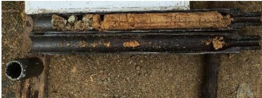
Foto 54 Roca blanda encontrada en las perforaciones realizadas para la Obra N°4 Fuente: El Autor
