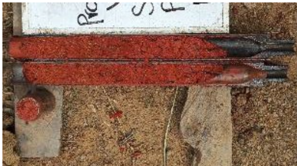
Foto 57 Suelo residual encontrado en las perforaciones realizadas para la Obra N°6
