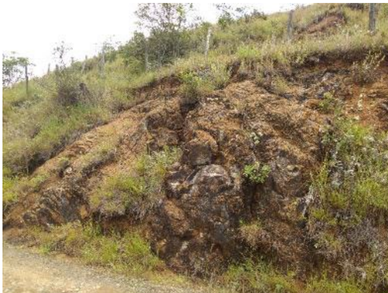
Foto 4 Aspecto general del macizo rocoso de la roca blanda de la Formación Volcánica. Fuente: El Autor
