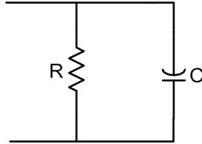
Al ser este circuito dual del anterior, el factor de mérito puede determinarse fácilmente, sustituyendo L por C y  $1/R$  por R:
