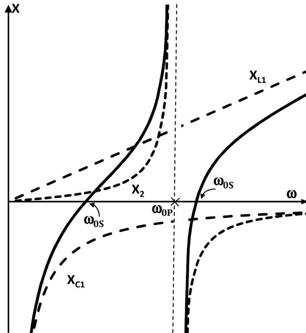
Observamos que el comportamiento del dipolo cambia varias veces con la frecuencia. También que existen tres frecuencias a la cual el dipolo tiene un comportamiento especial. Dos frecuencias a la cual la reactancia es nula (Resonancia serie) y una cuya reactancia tiende a infinito (Resonancia paralelo).
