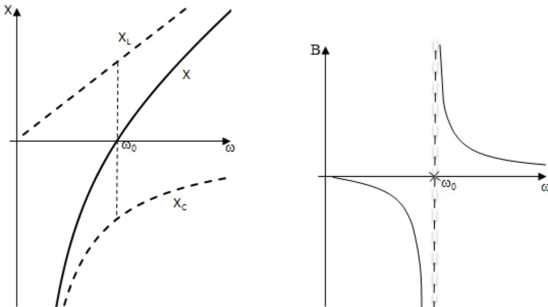
Observamos cómo cambia el comportamiento con el aumento de la frecuencia pasando de comportarse como capacitivo a inductivo y por un valor de  $\omega$  con la cual la reactancia es nula.
