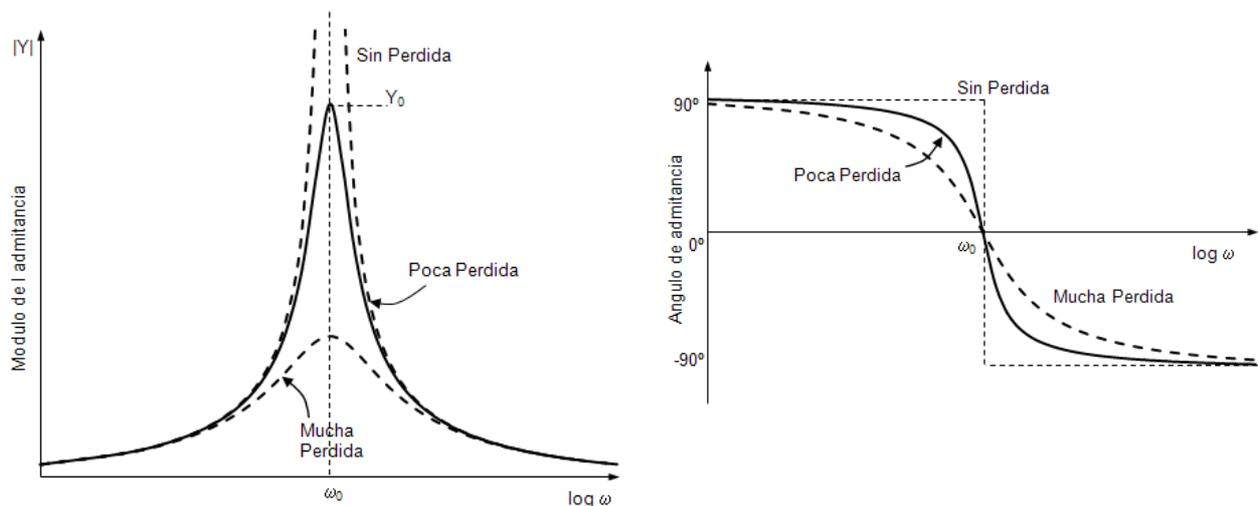
Fig. 4: Admitancia de un circuito serie, módulo y fase
