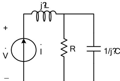
Respuesta:  $\omega_0 = \sqrt{\frac{1}{LC} - \left[ \frac{1}{R.C} \right]^2} \quad Z_0 = L / RC \ \Omega$
