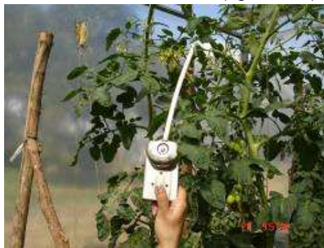
Figura 113. Vibrador eléctrico operado por batería
