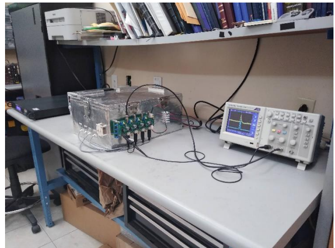
Figura II.C.2. Muestra del Sistema de aislamiento óptico 6 , al cual se le ensambla la tarjeta electrónica que alimenta a los fotodiodos y con las cuales se tiene la lectura analógica y digital de las señales eléctricas producidas por los fotodiodos con ayuda de una base de metal 7 . Se observa en el osciloscopio la salida analógica y digital de una señal eléctrica de uno de los canales de la tarjeta, que corresponde a uno de los fotodiodos conectados o al material de prueba o a los detectores de veto.
