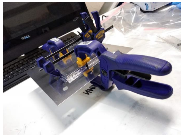
Figura II.B.2. Ensamblado de los detectores de veto con el plástico centellador dentro. Se cubrió con cinta de aluminio para evitar entradas de luz.
