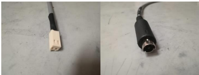
Figura II.B.4. Muestra del conector mox y mini-DIN respectivamente. Estos son los extremos de los conectores de 70cm.
