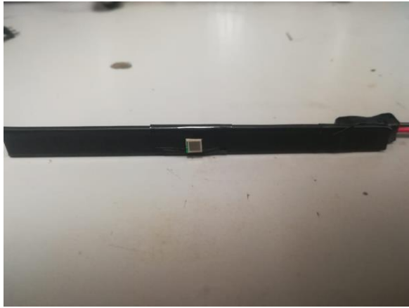
Figura II.B.3. Tarjeta 1. Tarjeta que tiene a un fotodiodo, la cual se une a un detector de veto. Se cubrió con cinta de aislar negra para evitar contacto eléctrico, además se pueden observar las conexiones eléctricas (alambre rojo, negro).
