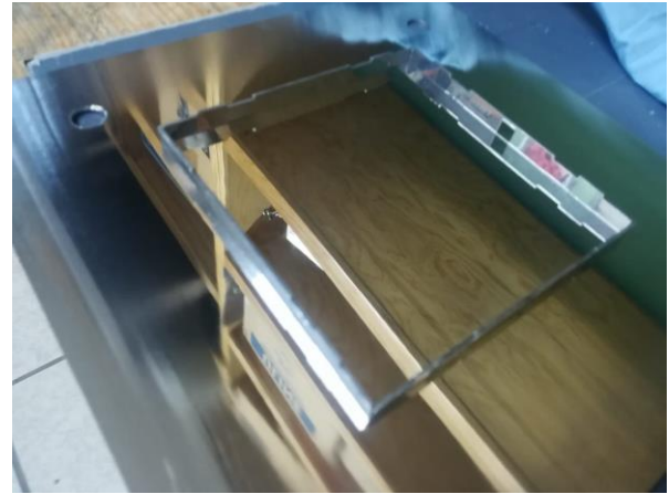
Figura II.B.1. Muestra de la estructura de los detectores de veto antes de colocar el plástico centellador. El material de los elementos es aluminio debido a que es altamente reflectivo.
