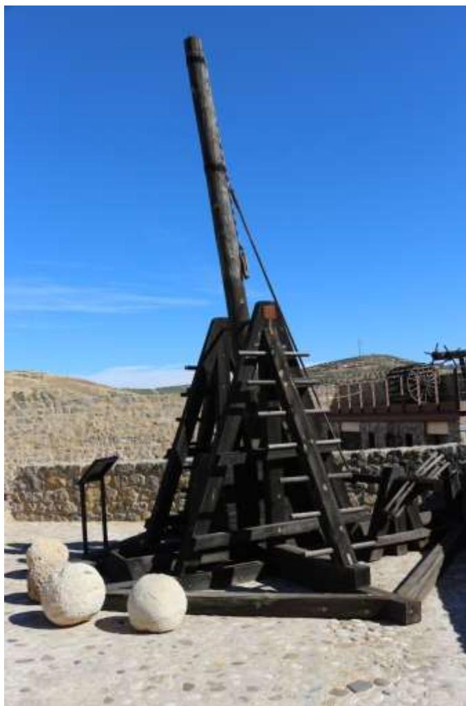
Fig. 1. Réplica de un tipo de almajaneque, el trabuquete, una de las máquinas de la artillería neurobalística. Castillo de Alcaudete. Fotografía: J. A. Miranda.
