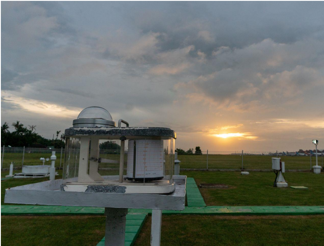
Piranógrafo (también llamado pirheliógrafo) instalado sobre un pedestal en el jardín de un observatorio meteorológico, junto a otros instrumentos.
