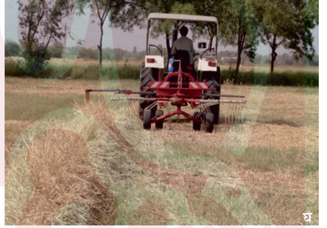
रेकर (पसरविलेला चारा गोळा करण्याचे यंत्र)
