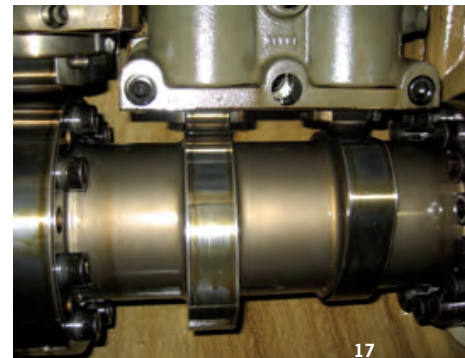
Árbol de levas en el momento de la inspección y previo a su limpieza
