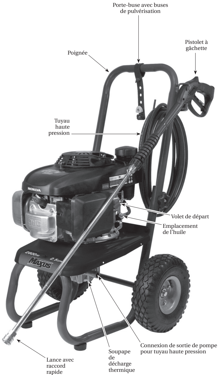
Figure 7 - Composants de la laveuse à pression
