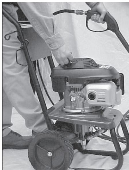
Figure 16 - Démarrage du moteur
