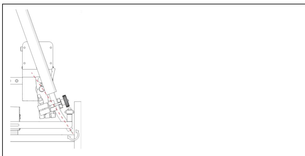
Afin d'obtenir une forme correcte d'oscillation, les axes de l'arbre de sortie de l'oscillateur et la torche de soudage doivent se croiser.
