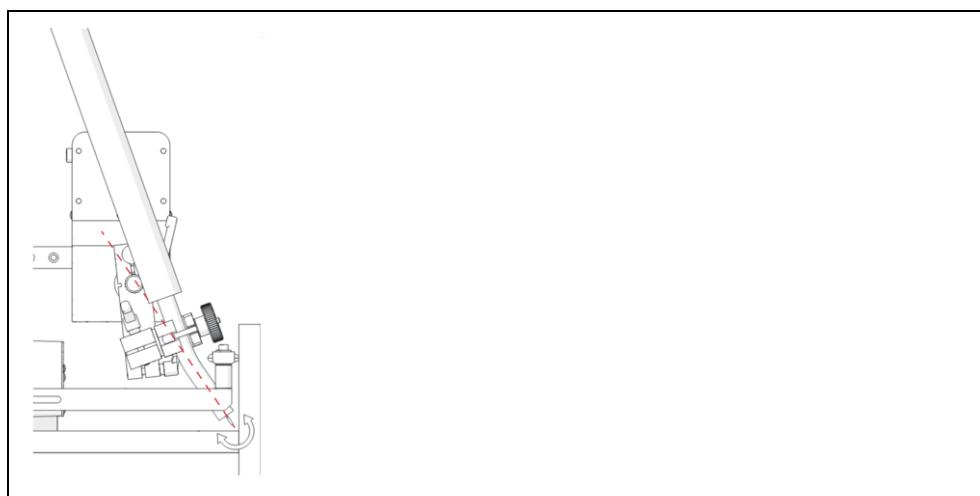
Para mantener la forma correcta de la oscilación, el eje del husillo de salida del oscilador y el de la antorcha de soldadura deben cruzarse.
