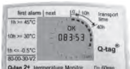
测量运行, 没有警报状态下显示所经历的运输时间
