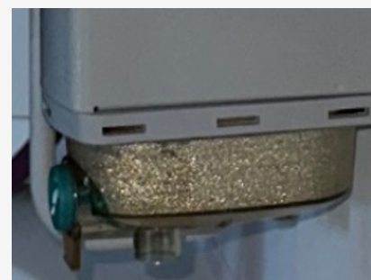
Figura 4: Condensación del reservorio.
