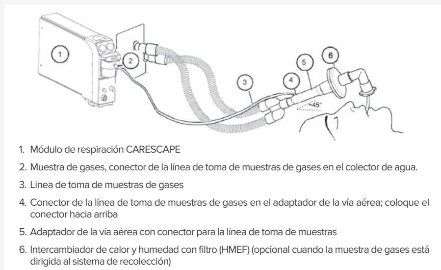
Figura 5: Instalación de la medición de gases
