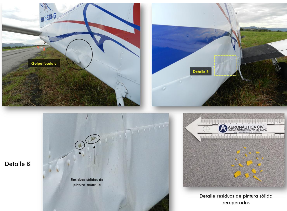
Detalle de evidencias en la sección derecha baja del fuselaje HK1328G
