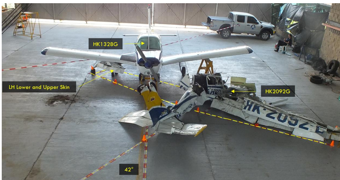
Reconstrucción de restos aeronave HK2092G y su interacción con la aeronave HK1328G
