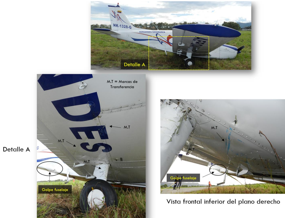
Detalle de evidencias por marcas de transferencia en la sección del ala derecha HK1328G
