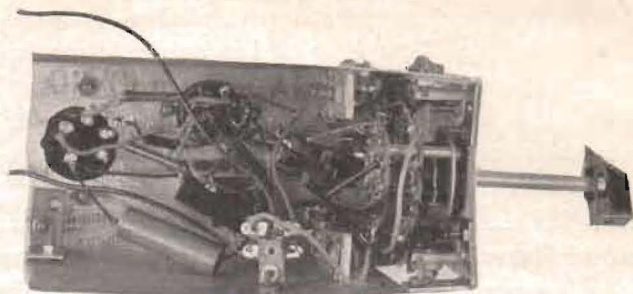
Chassiet från undersidan. Man ser Yaxley-omkopplarens två sektioner samt trimmkondensatorerna.
