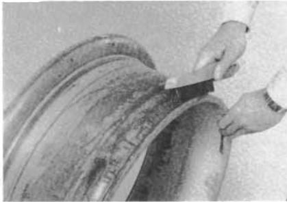
Completamente limpiar el óxido, tierra, y otras materias extrañas de todas las superficies. Los cepillos de mano o eléctricos o soplete de arena pueden ser utilizados. El canal en la base del rin debe de estar despejado de óxido y otras materias que pudieran obstruir el asiento de los arillos.
