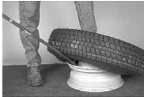
1. Antes de aflojar alguna de las tuercas que aseguran el montaje del neumático y del rin al vehículo, extraer el núcleo de la válvula y desinflar el neumático completamente. Si se está trabajando con dobles/duales, desinflar ambos neumáticos completamente. Pasar un alambre a través del cuello de la válvula para asegurar el desinflado:
