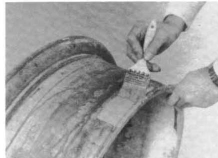
Pintar el rin con brocha o rociador con un antioxidante de secado rápido. Las superficies deben de estar limpias y secas antes de pintar. Asegurar que las áreas de metal sin pintura en el exterior o lado del neumático del rin estén cubiertas. Esto es especialmente importante en rines sin cámara de drop center, porque el aire caliente y a veces húmedo está en constante contacto con la superficie de metal en el lado del neumático del rin.
