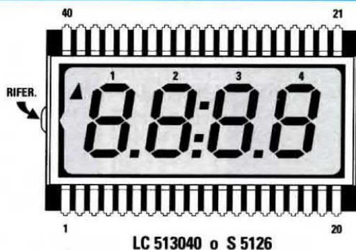
Fig.20 Sebbene il display LCD da utilizzare in questo Analizzatore sia un LC.513040 e equivalente all'S.5126, non troverete mai queste sigle stampigliate sul retro del suo corpo. Il display LCD che trovate nel kit è uno dei due sopra citati.
