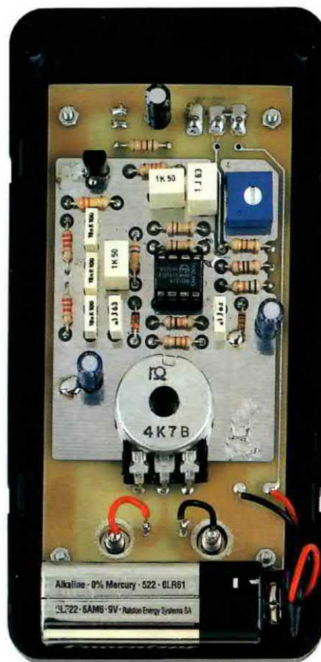
Fig.9 Foto del Generatore BF già fissato all'interno del mobile. Nello spazio posto in basso viene inserita la pila da 9 volt.
