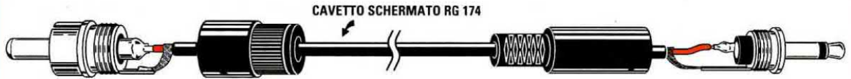
Fig.6 Per collegare l'interfaccia al Ricetrasmittitore e al Computer dovete utilizzare dei corti spezzoni di cavetto coassiale tipo RG.174. Ad una estremità di questo cavetto va collegato lo spinotto maschio tipo RCA e sull'estremità opposta una presa jack mono. La calza di schermo di questo cavo va saldata sul corpo metallico delle due prese.
