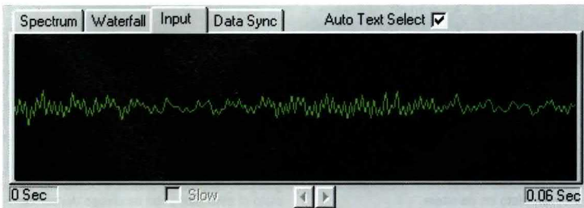
Fig.17 Quando l'ampiezza del segnale di BF risulta correttamente dosata, sullo schermo appare un segnale seghettato, ma molto uniforme, simile a quello qui sopra riportato. Ora potete andare nella finestra dello spectrum (vedi fig.33) e se vedete uno o più picchi a V rovesciata vuol dire che vi sono delle emittenti che trasmettono in PSK31.
