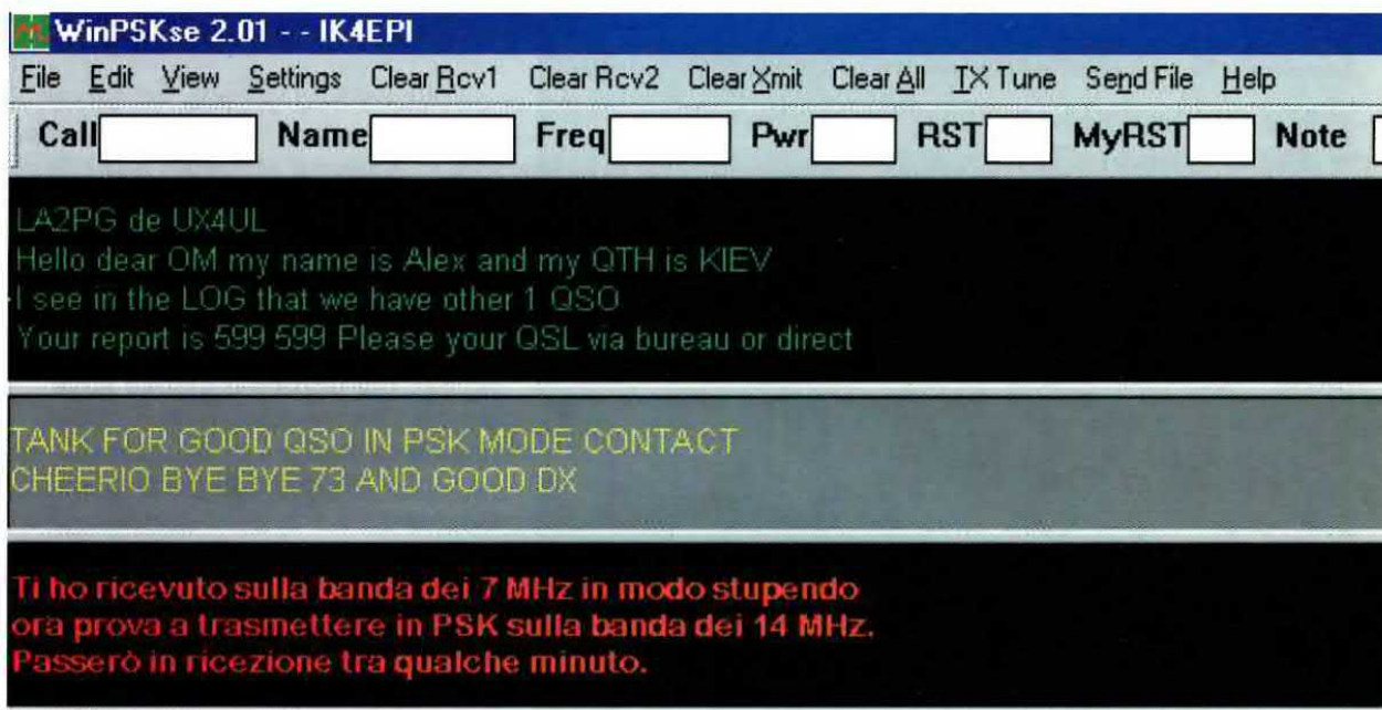
Fig.40 Nelle prime due fasce poste in alto visibili sullo schermo, appaiono i testi di ricezione di RX1 (vedi scritta in colore verde) e di RX2 (vedi scritta in colore giallo), nella terza fascia appare il testo che volete trasmettere al vostro corrispondente (vedi scritta in colore rosso). Il testo da trasmettere può essere digitato direttamente da tastiera oppure richiamato con le macro memorizzate nei tasti funzione da F1 a F10.
