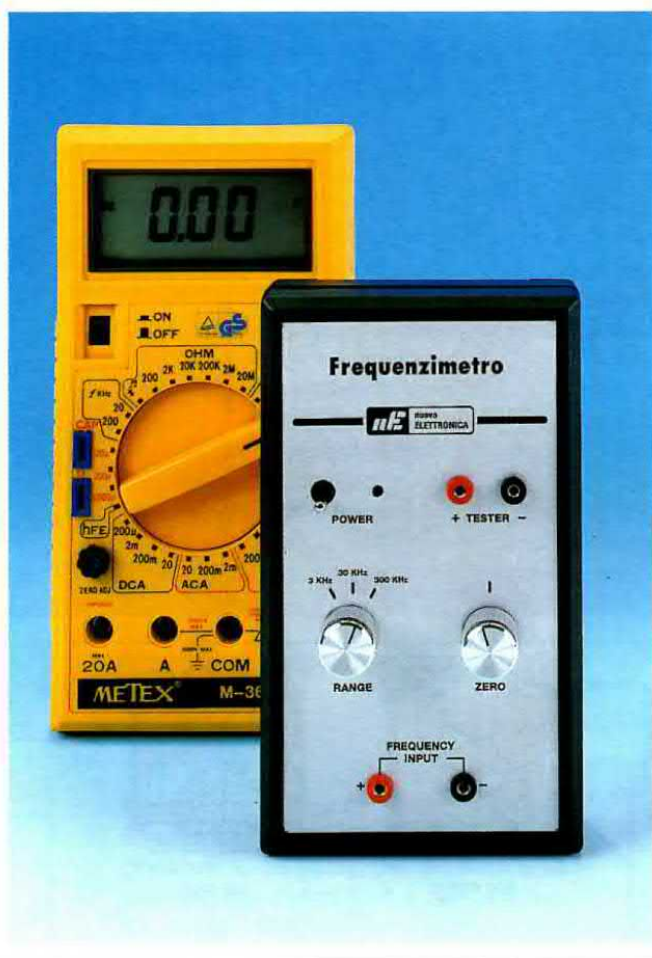
Fig.561 Per leggere la tensione potete utilizzare un tester analogico a lancetta oppure un tester digitale con display LCD.
