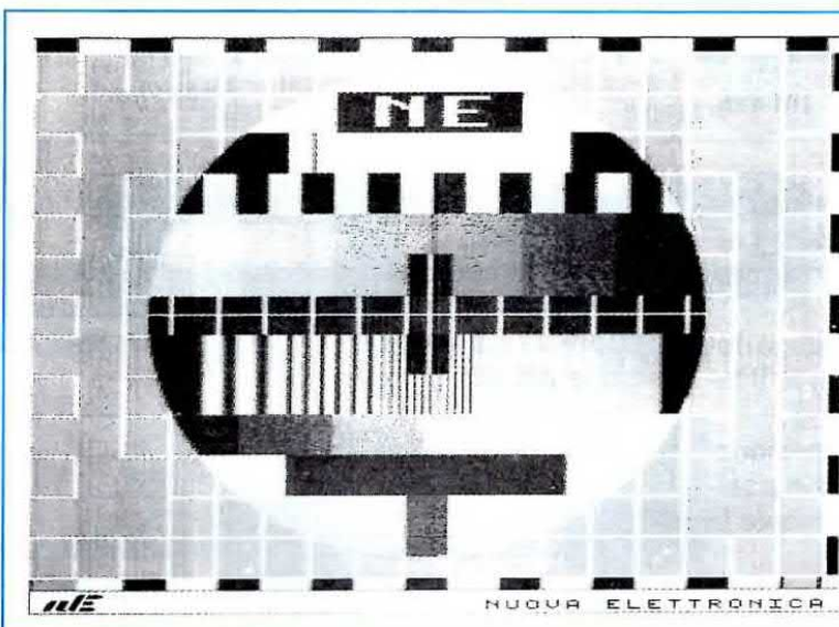
Fig.22 Se l'immagine stampata appare molto chiara, significa che il segnale VIDEO è esagerato, pertanto la si potrà rendere più scura ruotando il TRIMMER R1 (vedi fig.7), oppure ruotando leggermente il potenziometro del contrasto R3.
