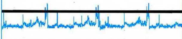
Fig.24 Se l'immagine avrà una prevalenza di toni GRIGI, il segnale rimarrà al centro tra le due linee e salirà verso la linea superiore in presenza di zone bianche o scenderà verso la linea inferiore in presenza di zone nere.
