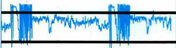
Fig.25 Segnale dell'immagine di un satellite polare NOAA. Non preoccupatevi se l'immagine che appare sullo schermo appare troppo scura o troppo chiara, perchè una volta completata, la potrete sempre schiarire o scurire agendo su tasti F7-F8.
