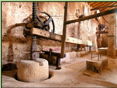
Prensa de viga. Son Torrella (Santa Maria del Camí). Prensa mecánica. S'Alqueria Vella de Baix
