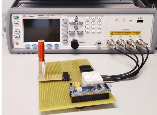
Figura 26: Imagen del sistema de medición inicial desarrollado en el laboratorio, donde se puede observar el medidor LCR *Keysight E4980A* y la conexión de tipo Kelvin estándar, la bobina de medición, el microcontrolador *Maple Mini Board* encargado de generar la señal de desimantación y el sistema de relés encargado de la protección del sistema de medida.
