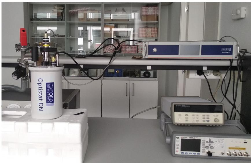
Figura 33: Imagen del sistema global en el que se puede observar el medidor LCR *Keysight E4980A*, el criostato *Optistat DN*, el controlador de temperatura *Oxford Instruments MercuryiTC* y el sistema de adquisición de datos *Keysight 34970A* y sus interconexiones. En la imagen no se encuentra ni el módulo de desimantación ni las conexiones y la bobina de medición.
