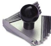
SCROLLRULER 295/XV: universelles Gitterschnittlineal, durch Drehen des Rändelrads einstellbar: Schnittabstände (6 x 1 mm, 6 x 2 mm, 6 x 3 mm, 11 x 1 mm, 11 x 1,5 mm).
