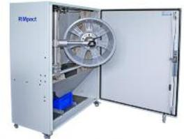
RIMPACT II zum Steinschlagprüfgerät 508 VDA, zur normgerechten Prüfung nach VDA an ganzen Felgen bis 26" (Einhaltung des vorgegebenen 54°-Beschusswinkels).
