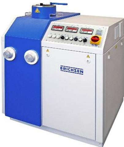
**Elektro-hydraulisch angetriebene und automatisch gesteuerte Blechprüfmaschine**
