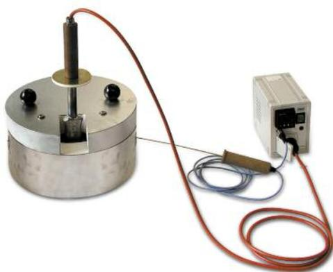
Beheizbare Warmzieh-Vorrichtung zur Durchführung der Tiefzieh-Näpfchen-Probe bis 550 °C. Ausgestattet mit einem elektronischen Temperatur-Regelgerät mit Soll- und Ist-Wertanzeige. Das Aufheizen der Bleche erfolgt außerhalb der Prüfmaschine. Elektrisch aufheizbare Blechhalteplatten und Ziehmatrizen können leicht eingelegt und ausgewechselt werden.
