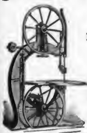
No. 3. Re-ascerradora continua.
