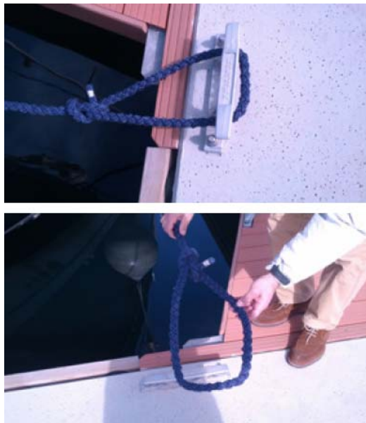
Figura 3.77 Encapillar Fuente: Propia
