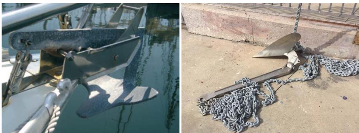
Figura 3.69 Ancla de arado y de arado CQR basculante. Fuente: Propia
