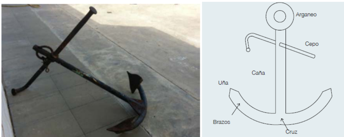
Figura 3.68. Partes de un ancla con cepo. Fuente: Propia
