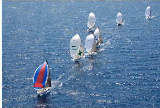
Figura 3.43- Veleros navegando en popa cerrada en una regata con spinnakers. Fuente Propia
