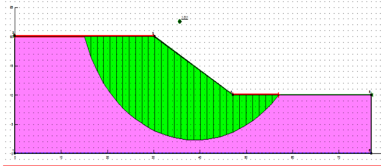
Figura 4.11. Representación de la superficie de deslizamiento para la cohesión de 34.4 \text{ kN/m}^2 en GEOSTUDIO 2004.
