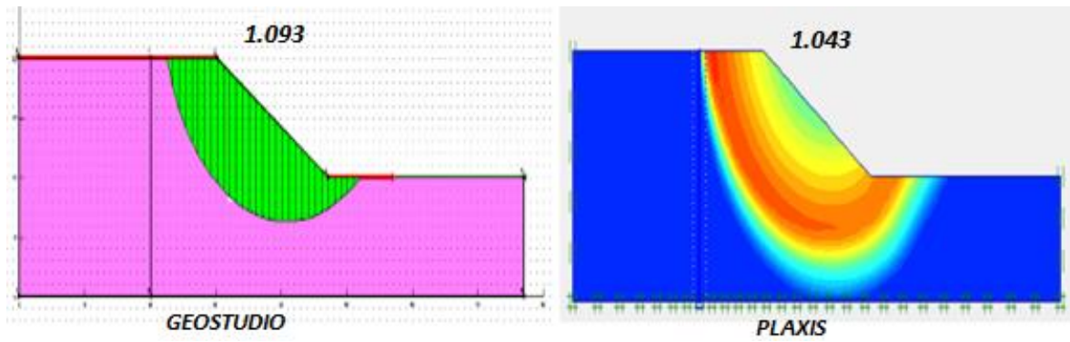
Figura 4.34. PLAXIS Vs. GEOSTUDIO, posición del pilote s=27m .
