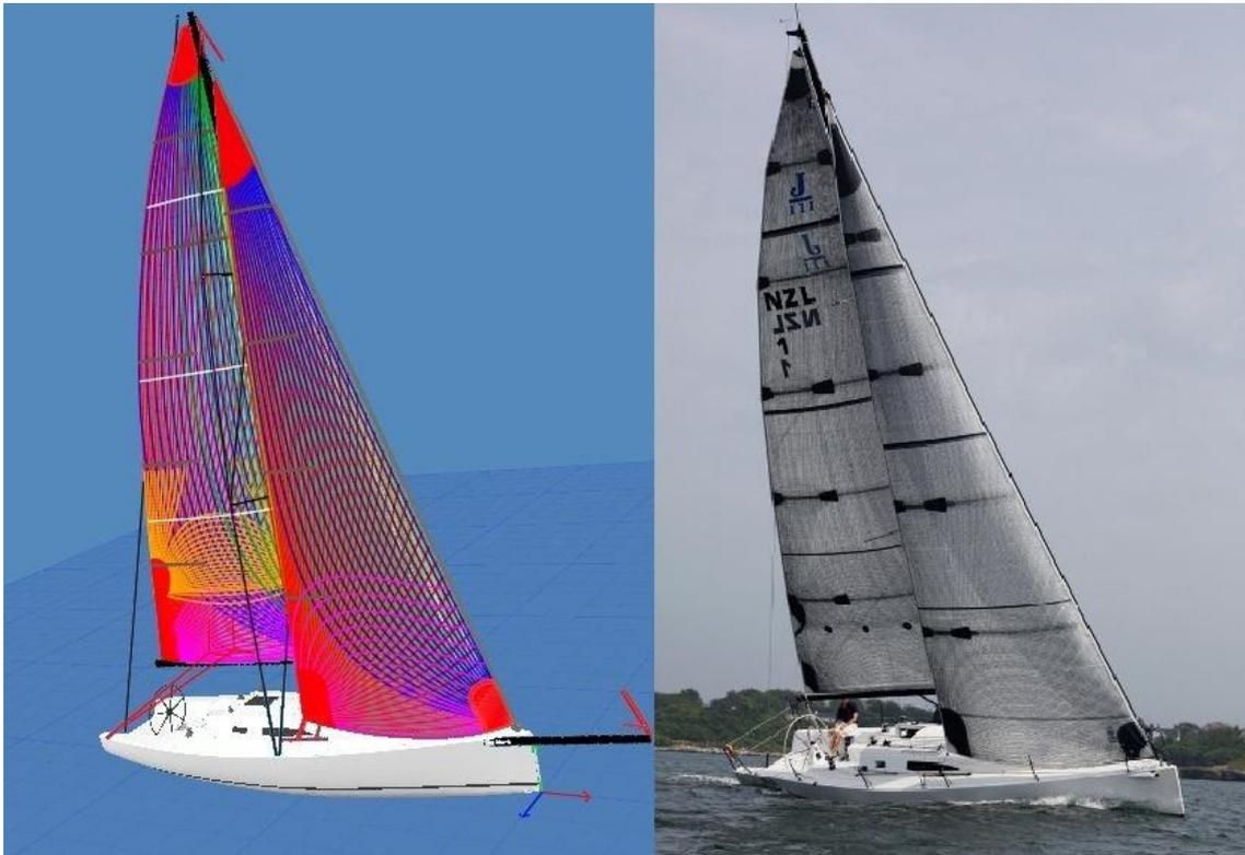
**Figura 6-1 Diseño y fotografía de las velas de un J/111
