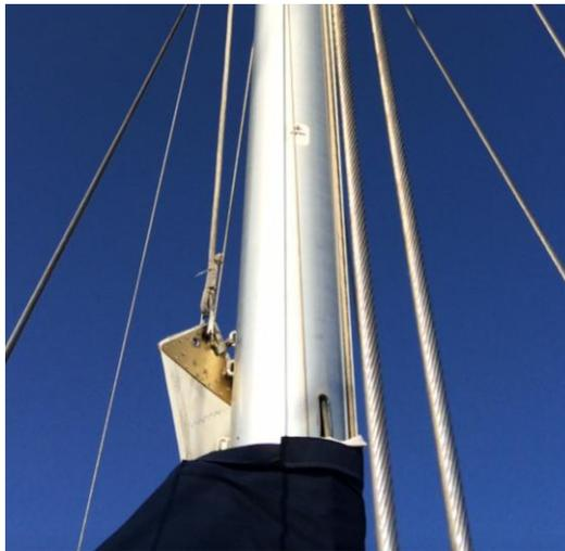
**Figura 5-4 Jarcia de filamento trenzado**
