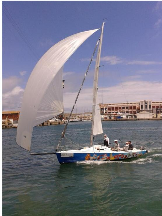
Figura 4-21 *Spinnaker* asimétrico
