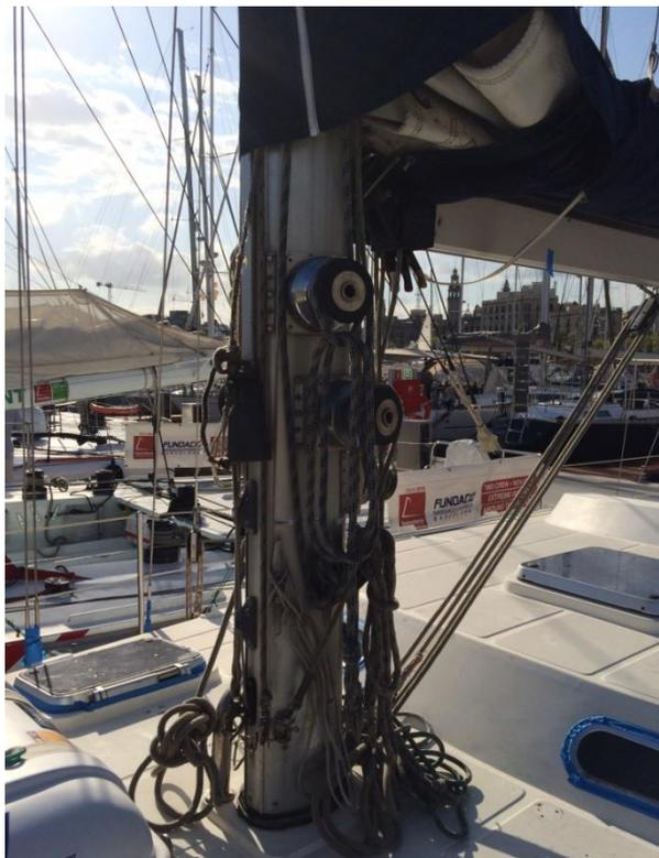
**Figura 7-3 Fognadura del mástil y jarcia de labor del velero Barcelona**
