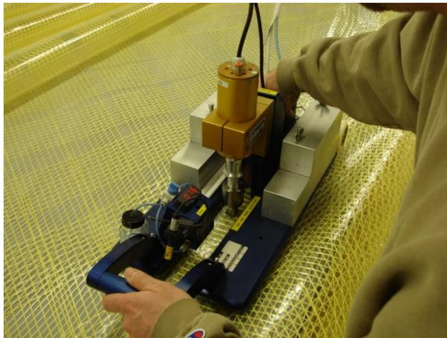
**Figura 6-20 Máquina que proporciona una unión mediante la aplicación de ultrasonidos
