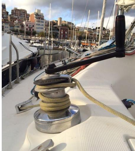
**Figura 2-2 Winch con un cabo fijado en el *self* y la maneta**
