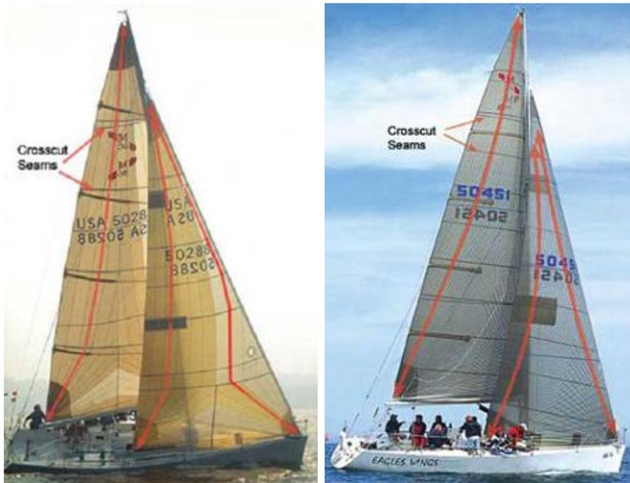
Figura 6-18 Comparación entre unas velas tri-radiales y unas *Tape-drive*
