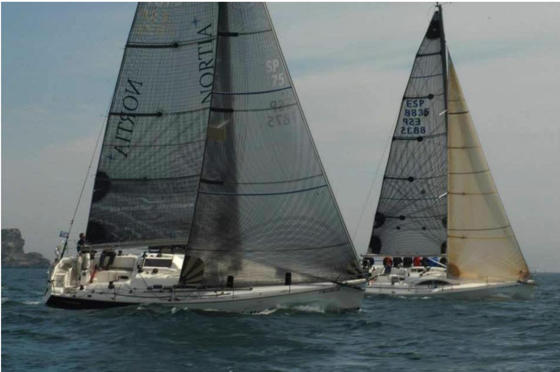
**Figura 4-16 Fotografía de un génova y un foque**
