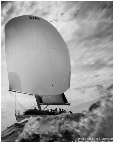
Figura 4-23 *Spinnaker* simétrico
