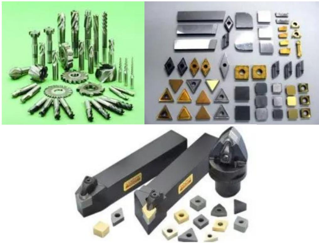
*Figura 19. Diferentes tipos de herramientas según el material. Acero rápido, acero duro y cerámico
