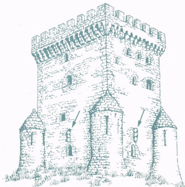
Fig. 209.- Torrona de Celigüeta (Sangüesa, Navarra). Probablemente construida en la segunda mitad del siglo XV como una torrona convencional a la que se añadieron desde un principio cuatro cortos borjes aspillados en las correspondientes esquinas, hasta media altura, cubiertos con chapiteles cónicos para minimizar la interferencia con la defensa vertical de los adarves, que en su aspecto actual responden a reciente restauración. En cada lienzo, a la altura de las aspilleras rasantes, sendos redientes deflactores.
