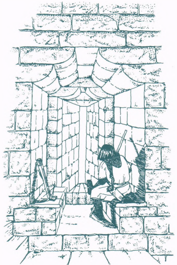
Fig. 69.- Restitución de una cámara de tiro neurobalístico hacia 1400, parcialmente basada en las existentes en la planta alta de la torre de Lopera (Utrera, Sevilla).
