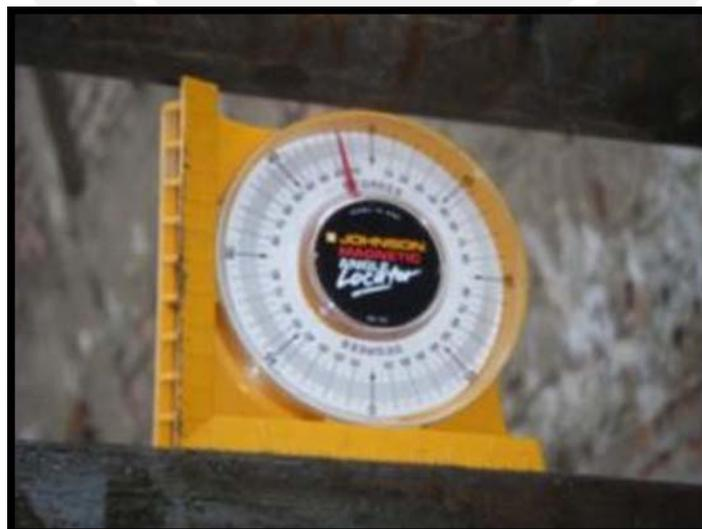
Imagen 18. Medición de ángulo de perforación
