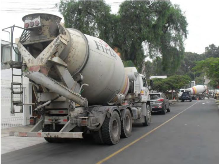
*Fig. A5.9: Camiones con concreto, esperando su turno de vaciado. En algunas ocasiones estas esperas suelen ser muy largas perjudicando la calidad del concreto.*
