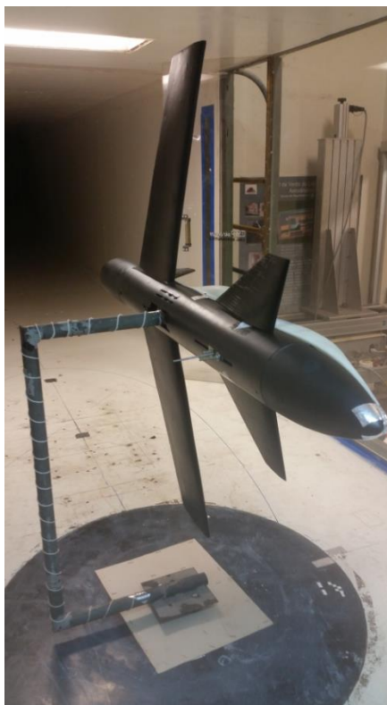
Figura 86 – Detalhe da haste de fixação do modelo na balança
