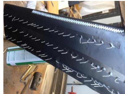
(d) Fixação de trip wire e tufts
