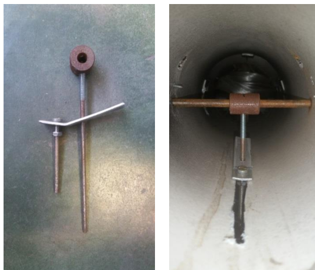
Figura 41 - Dispositivo utilizado para a variação do ângulo de incidência do Canard
