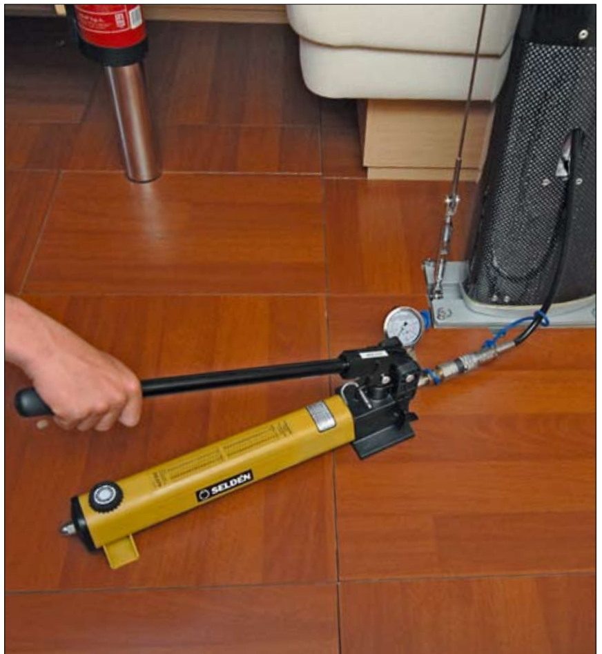
... y se puede acoplar fácilmente a la bomba para ajustar la tensión de la jarcia.
