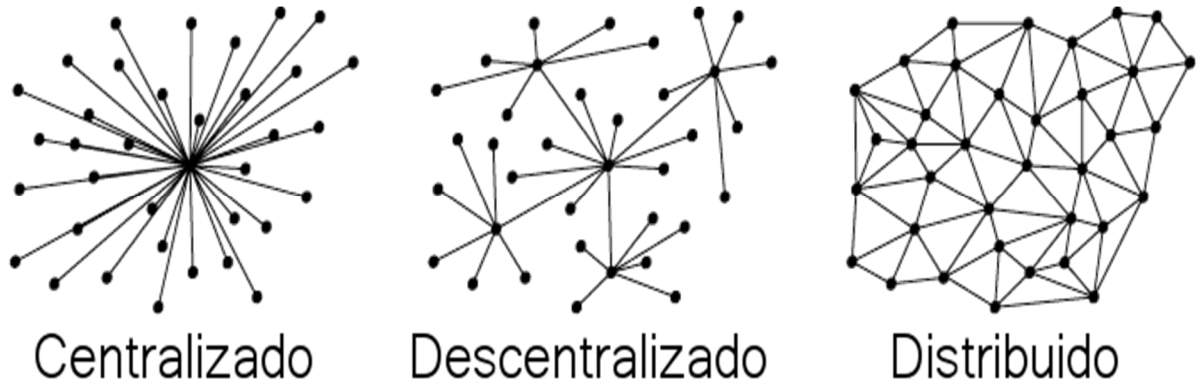
Figura 1. Centralizado vs Descentralizado vs Distribuido.
